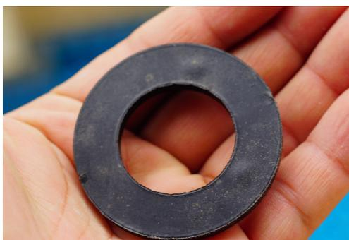
Des joints en élastomère chargés avec NANOMAG-Fe sont utilisés au niveau des connectiques d'un boîtier métallique.
